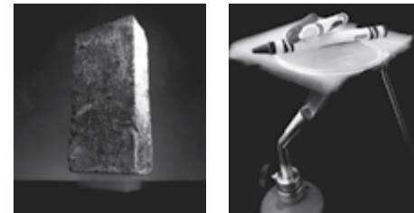
תמונה 5: אירוג'ל (Aerogel): חומר בעל תכונות חומריות חדשות. מימין: אירוג'ל כמבודד חום. משמאל: המחשת חוזק: לבנת אירוג'ל שמשקלה 2.5 גרם נושאת לבנת אבן שמשקלה 2.5 ק"ג, הנראית כמרחפת. באדיבות NASA/JPL-Caltech
