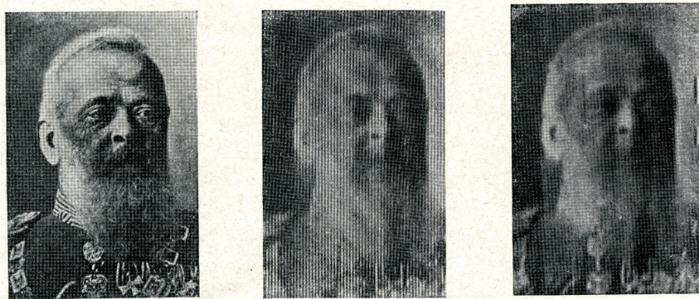
ארתור קורן (Korn), דיוקן של לואיטפולד, הנסיך העוצר של בוואריה, ולצידו שתי טלגרמות צילום שנשלחו כבדיקה של מערכת הטלפוטוגרפיה שפיתח. התצלום המקורי (משמאל) שודר פעמיים: במרכז – גרסה שהועברה במשך 12 דקות; מימין – גרסה שהועברה במשך 24 דקות. פורסם בעיתון Illustrierte Zeitung ב-26 באוקטובר 1905. Reproduction: Museum of Communication Frankfurt
